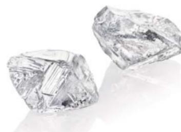
Два алмаза ювелирного качества, каждый крупнее 50 каратов, были извлечены на обогатительной фабрике №12 из руды трубки «Удачная». Более крупный алмаз массой свыше 67 каратов имеет размеры 30x20x14 мм. Второй – октаэдрический кристалл массой более 52 ка-
